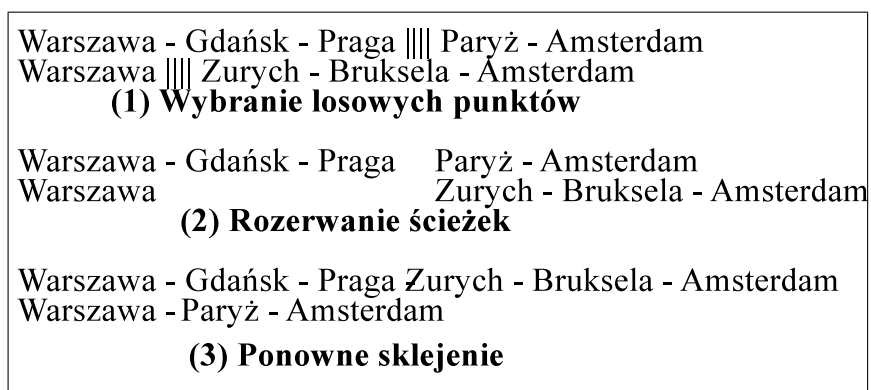
Rys. 1. Schemat przykładowej realizacji przebiegu operacji crossing-over dla dwóch ścieżek pomiędzy Warszawą a Amsterdamem
